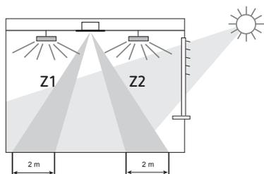
Chaque zone de mesure forme un rectangle d'environ 2 x 4 m sur le sol. En fonction du mode de fonctionnement et de la zone de détection sélectionnée, les mesures de la luminosité sont affectées comme suit :
